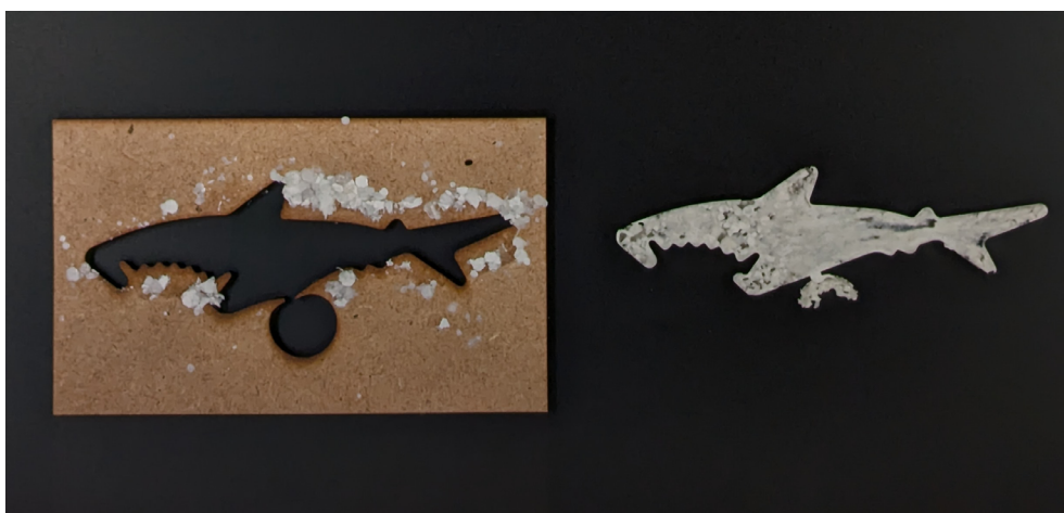
Requin en PLA blanc pressé sous papier cuisson/moule MDF ajouré/papier cuisson à la presse chauffante (t-shirt)
