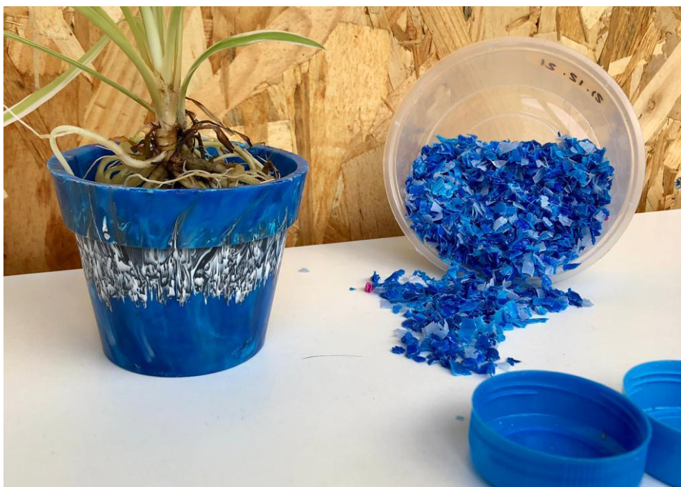
Des pots de fleurs moulés à partir de bouchons de lait (PP).
