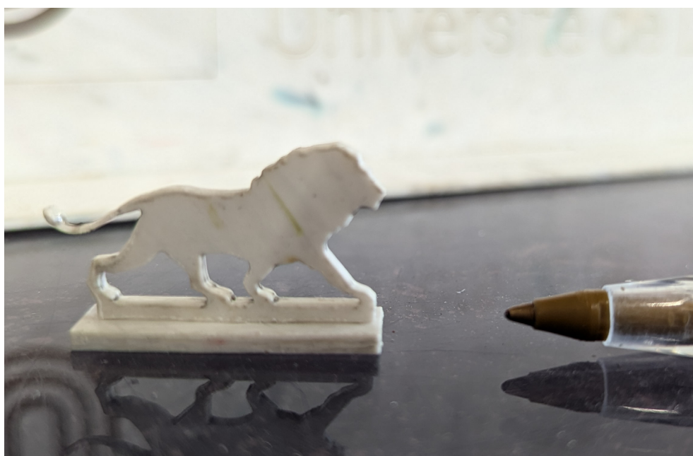
Plaque PLA blanc découpée et gravée à la LASER - assemblage par un point de colle cyano
