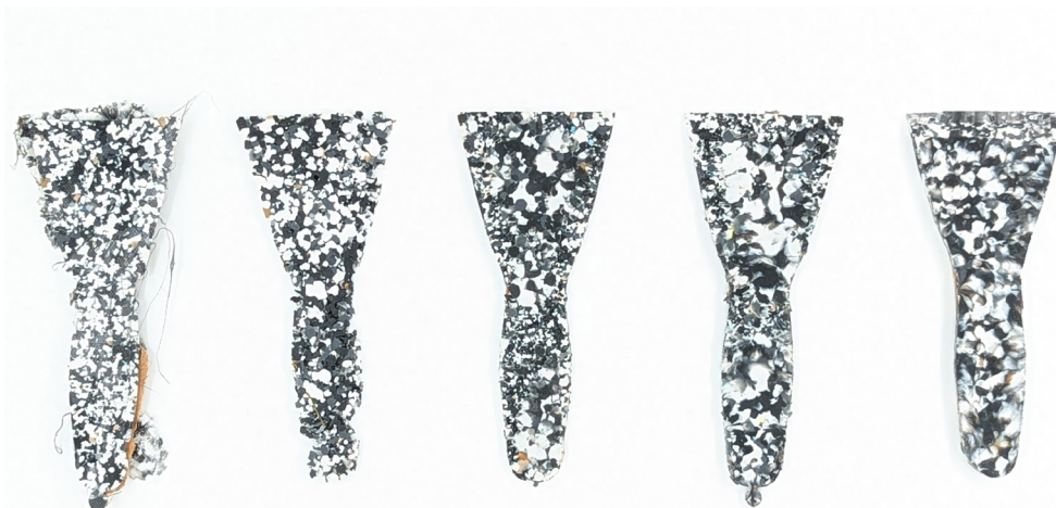
Évolution des tentatives pour réaliser une spatule à la presse chauffante (t-shirt). T°C, Temps de cuisson et grammage variant à chaque étape. Production retravaillé à la ponçeuse à bande sur table
